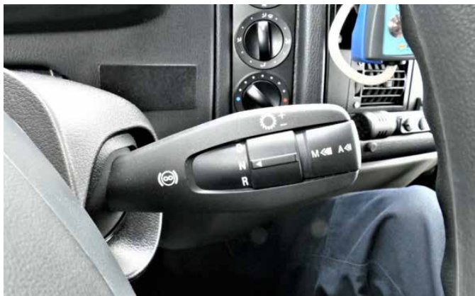
Obvolanska ročica ukazuje menjalniku in dekompresijski motorni zavori.
