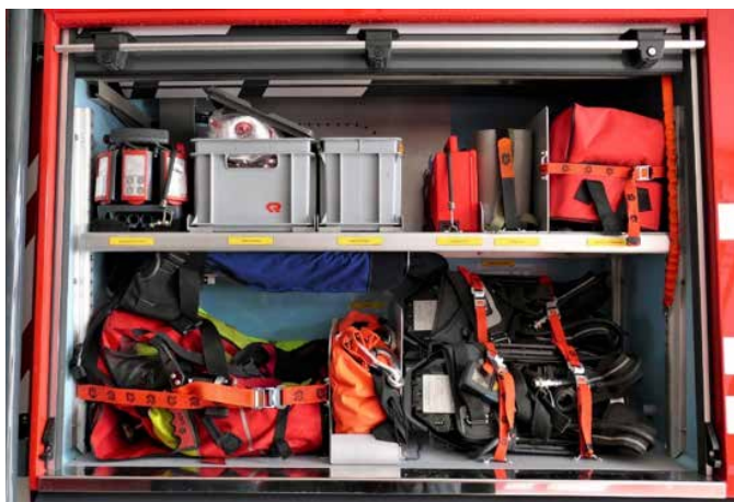
Oprema je spravljena v »omarah« na obeh bokih vozila, ki se zapirajo z roletami.
