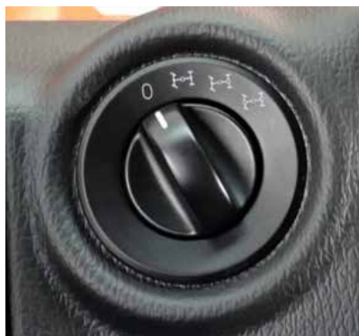
Z vrtenjem tega gumba v desno se terenske zmogljivosti zelo povečajo.
