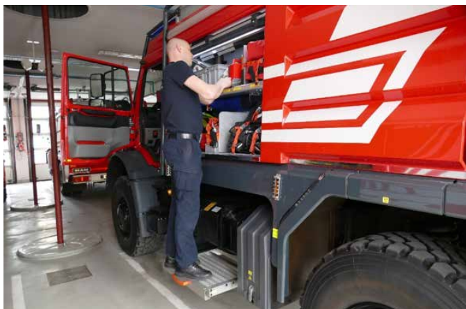
Oprema je odlično dostopna tudi zaradi izvlečnih stopnic na obeh bokih.
