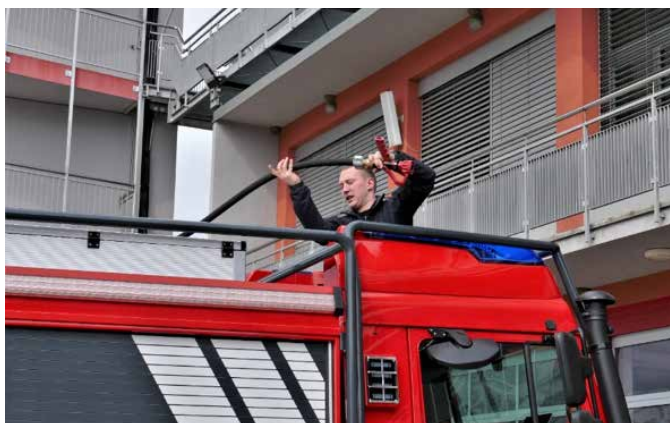
Član posadke lahko skozi loputo na kabini (tovarniška oprema) požar gasi že med vožnjo.
